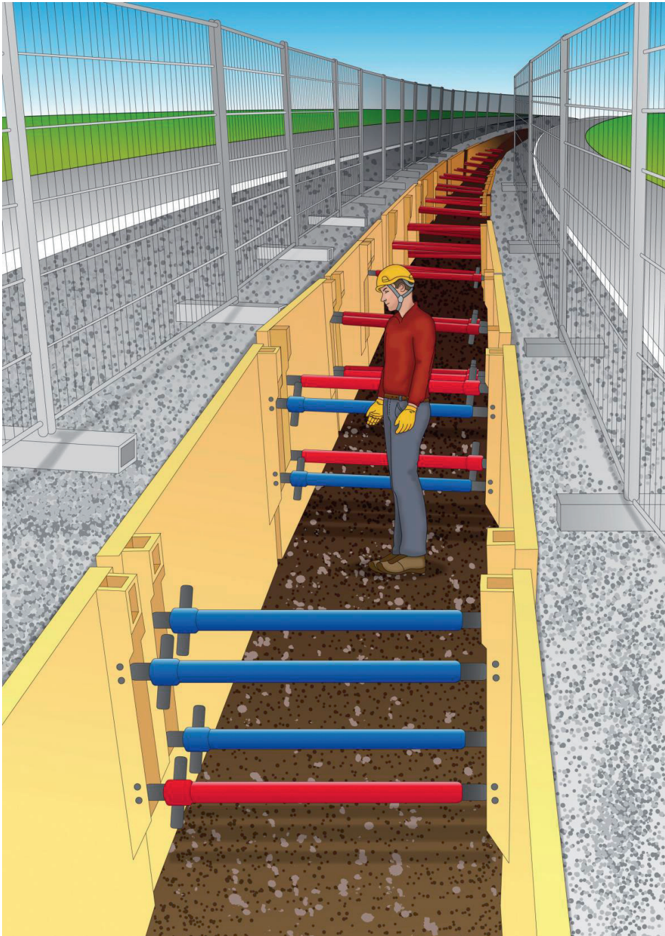
Figura 2 - Sistema di puntellazione per scavi supportato ai bordi con puntelli con regolazione variabile della lunghezza
